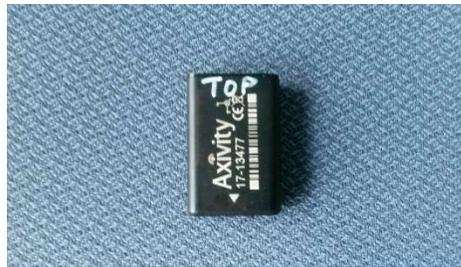
**Figure 1.** AX3 logging accelerometer
